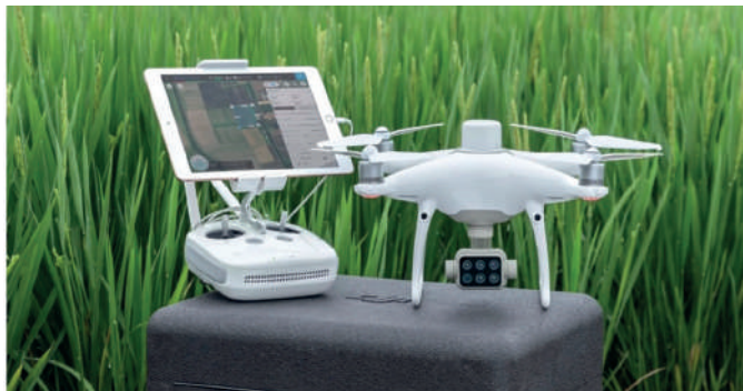
Figura 1. Dron DJI Phantom 4P MS RTK (izq.) y levantamiento en el Polígono 1 con RTK en junio de 2023 (der.)
